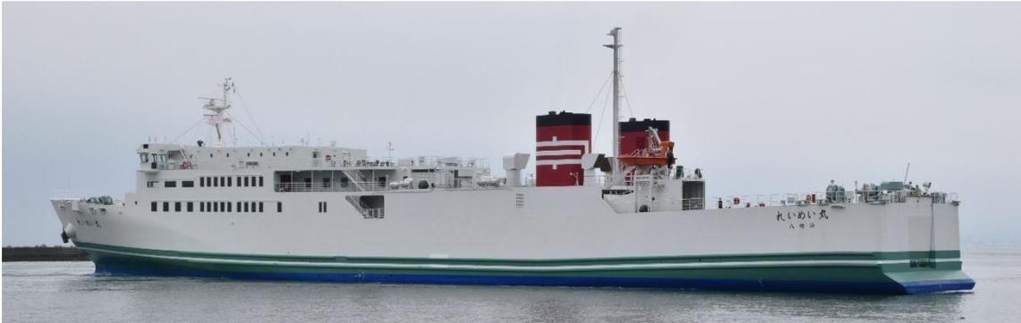
船尾端の喫水付近の張り出しは、走行中の抵抗を低減して、燃料消費量の削減にもつながっているとのことでした。
